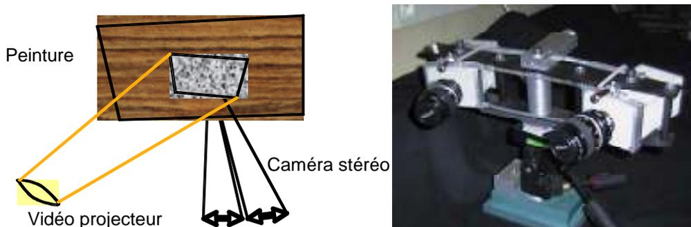
Figure 14. Dispositif de stéréo-corrélation avec compensation de lumière
