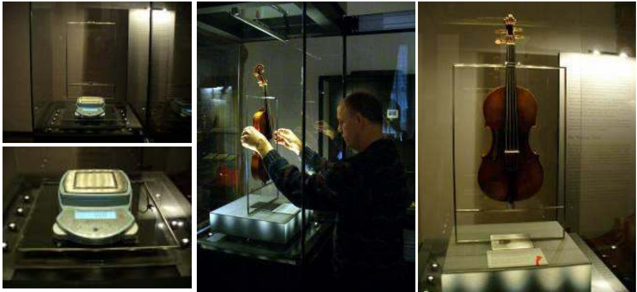
Figure 6 : Surveillance des variations de poids du Cannone . Le dispositif est constitué d'une balance de précision au centigramme, qui porte le poids de l'instrument et du support métallique.
