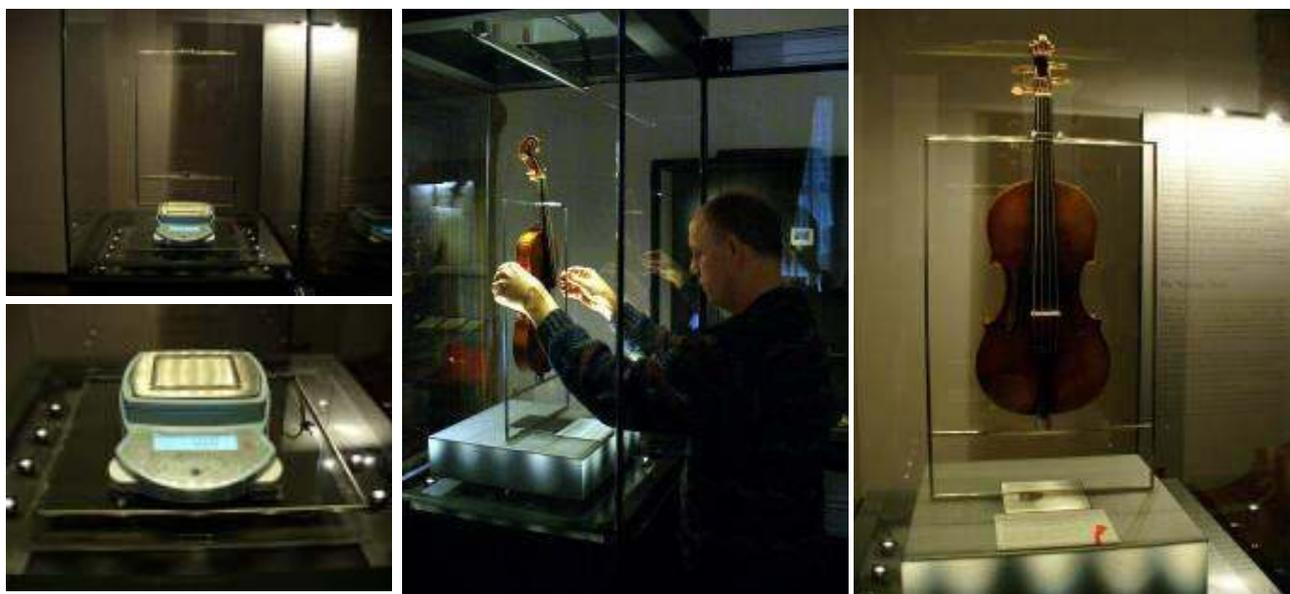
Figura 6: Monitoraggio delle variazioni di peso del Cannone. L'apparato è stato realizzato mediante una bilancia di precisione con risoluzione del centesimo di grammo, sulla quale grava il peso dello strumento e del dispositivo metallico di supporto.
