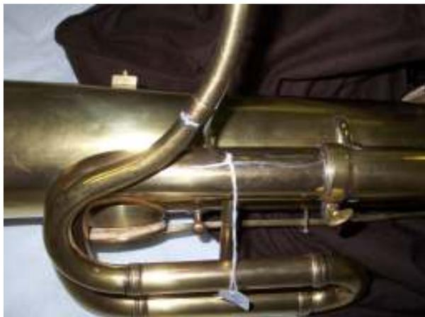
III. 10 – Fissure ouverte au niveau de la zone de soudure
