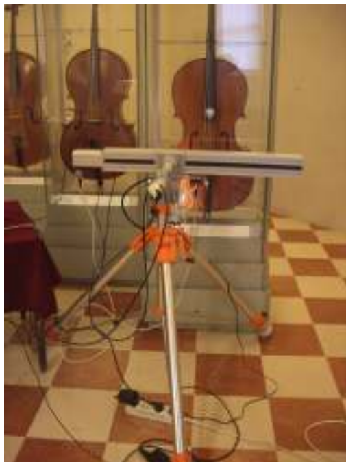
Fig. 1 – Système de mesure dendrochronologique utilisé pour cette étude. Dans certains cas, l'analyse dendrochronologique est possible à travers l'étui de l'instrument.
