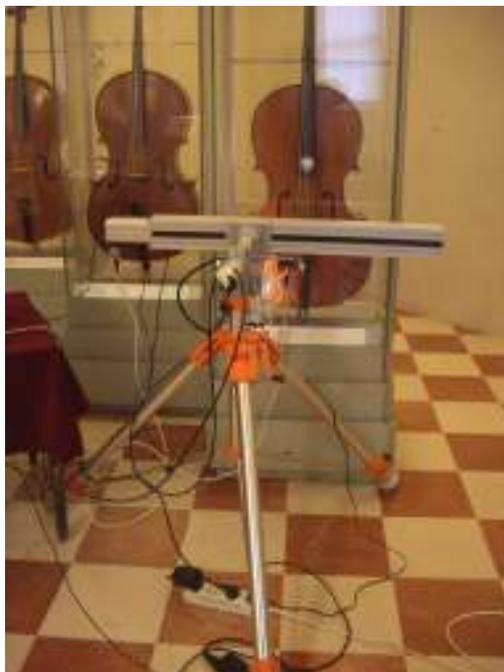
Fig. 1 – Système de mesure dendrochronologique utilisé pour cette étude.
