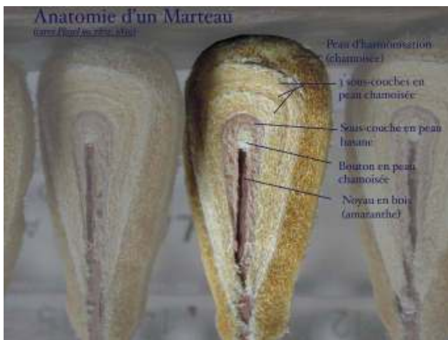
Fig. 1 : Anatomie d'un Marteau, marteau du piano carré Pleyel, n°7872, 1839.
