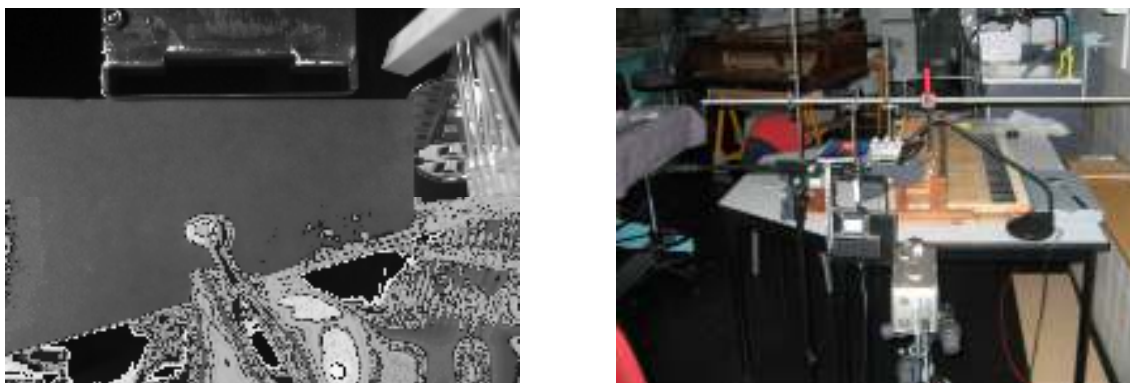
Ill. 5 - Dispositif expérimental (droite) permettant de filmer le mouvement d'un marteau du piano Érard 1802 (gauche)
