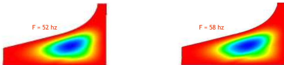
III. 7 - Effet d'une variation d'épaisseur sur le premier mode de vibration de la table d'harmonie
