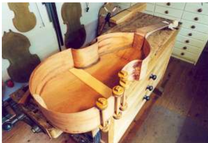
Fig. 6b - Réalisation du fac-similé de la basse de viole de Michel Collichon, Paris, 1683, Tilman Muthesius, Postdam, 2002.
