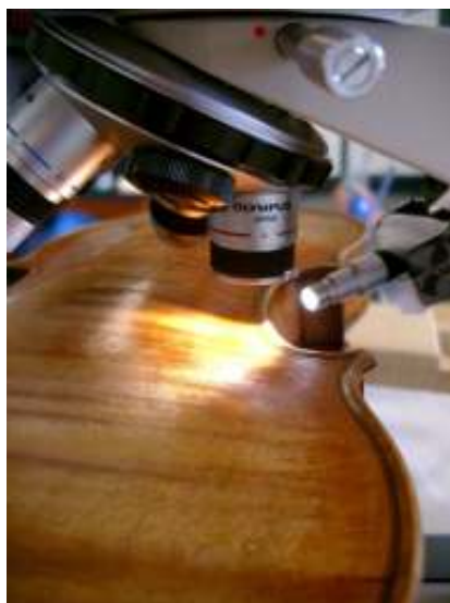
Figure 2 : Microscopie in situ du vernis d'un violon
