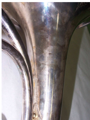
III. 5 - Traces d'empreintes digitales et noircissement de la surface argentée par formation de sulfures d'argent
