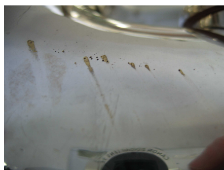
III. 8 - Bullage d'hydrogène formé lors d'un traitement électrolytique
