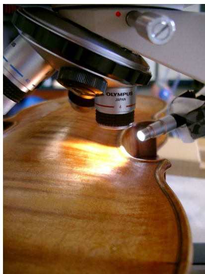
Figure 2 : Microscopie in situ du vernis d'un violon
